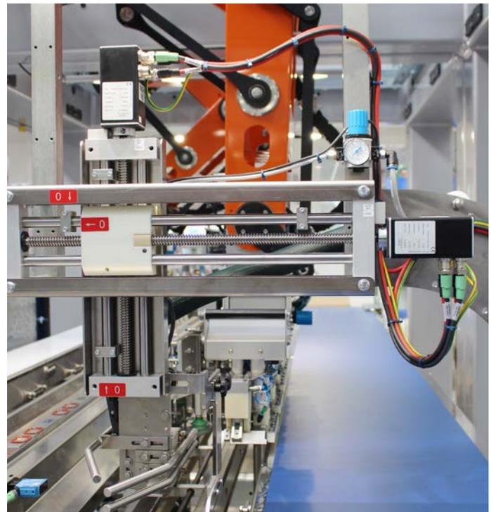
Abb. 4: Für die automatische Formateinstellung verwendet Schubert die Positioniersysteme der halstrup-walcher GmbH.
