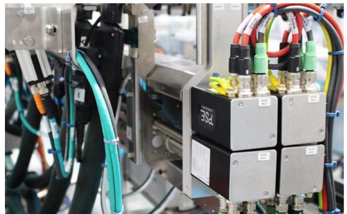
Abb. 2: Automatische Einstellung des Leimauftragsmoduls in der Kartonklebung mit Positioniersystemen PSE von halstrup-walcher
